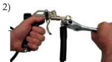
2) Montez le "pistolet de pulvérisation de base" sur le tuyau, en serrant bien l'écrou.
