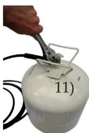
10) Raccordement du tuyau du primaire au spraytank.
